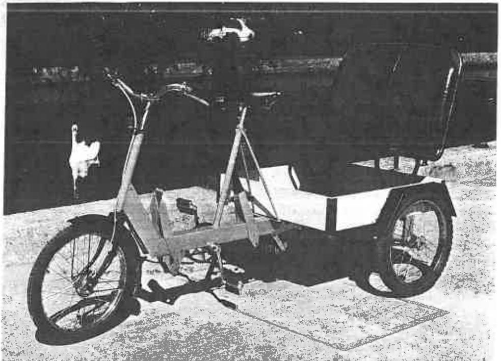
**Fig. 2-8** - *Un Oxtrike avec siège amovible*
