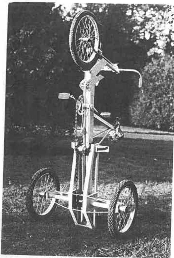
**Fig. 2-5** - Vue du cadre de l'Oxtrike relevé montrant la capacité de se garer dans un espace réduit, d'inspecter facilement la transmission et les freins et de décharger la marchandise.
