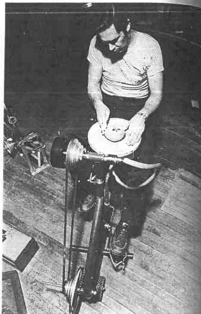
Fig. 3-10 - Roue de potier entraînée par le cycle à énergie
