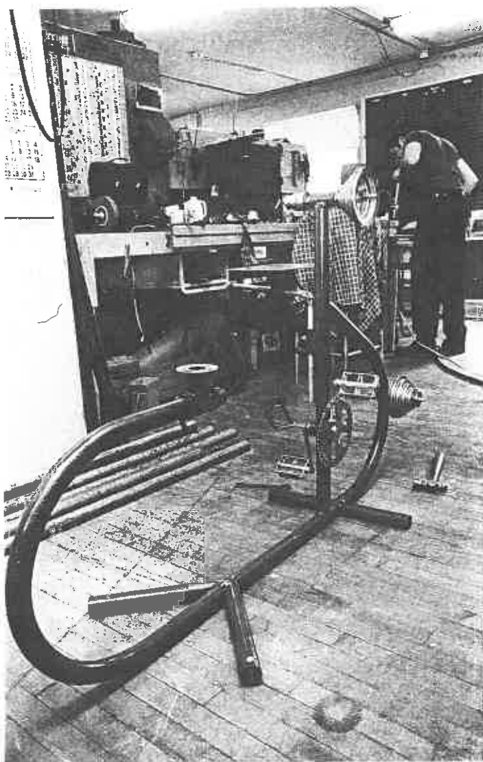
Fig. 3-5 - Simplification du cadre de bicyclette visant à réduire les matériaux, le poids et la largeur sans perte de stabilité
