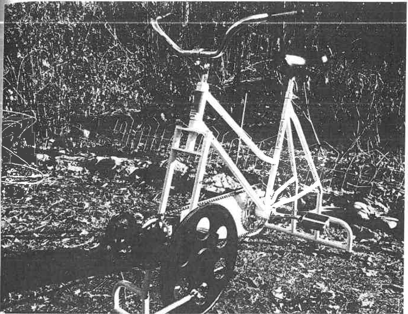
Fig. 4-1 - Moteur primaire entraîné par des pédales
